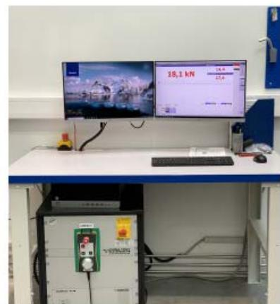
"FORM + TEST Prøfsystem, Alpha 3-2000S og Delta 6-100" hydraulisk presse og datalogging for spenningskurver brukt for bestemmelse av Enaksiell trykkfasthet, bøyestrekkfasthet, punktlast og brazilianer.
