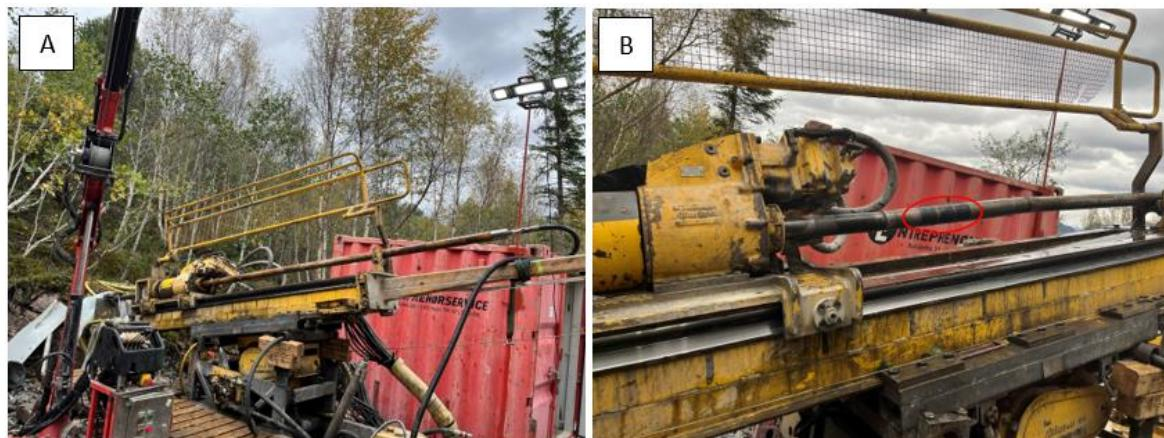
Figur 2-2 Oversiktsfoto fra borested. (A): Foto av kjerneboringsutstyret (Diamec U8) under boring. (B) Klargjøring for vanntapsmåling, rød sirkel markerer pakkere
