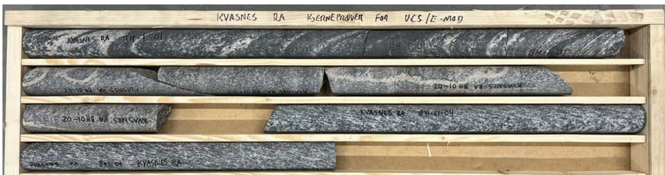
**Figur 1 Mottatt kjernekasse med prøver til UCS, E-mod og Poisson's forhold**
