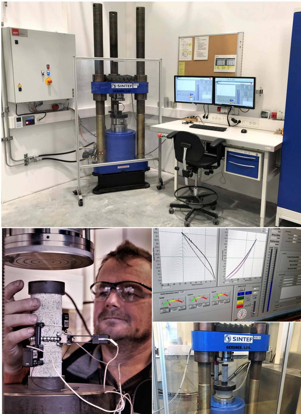
"Robcon" hydraulisk presse og datalogging for spenning-tøyningskurver brukt for bestemmelse av E-modul, Poisson`s forhold, enakssiell trykkfasthet og strekkfasthet (Brazililianer).
