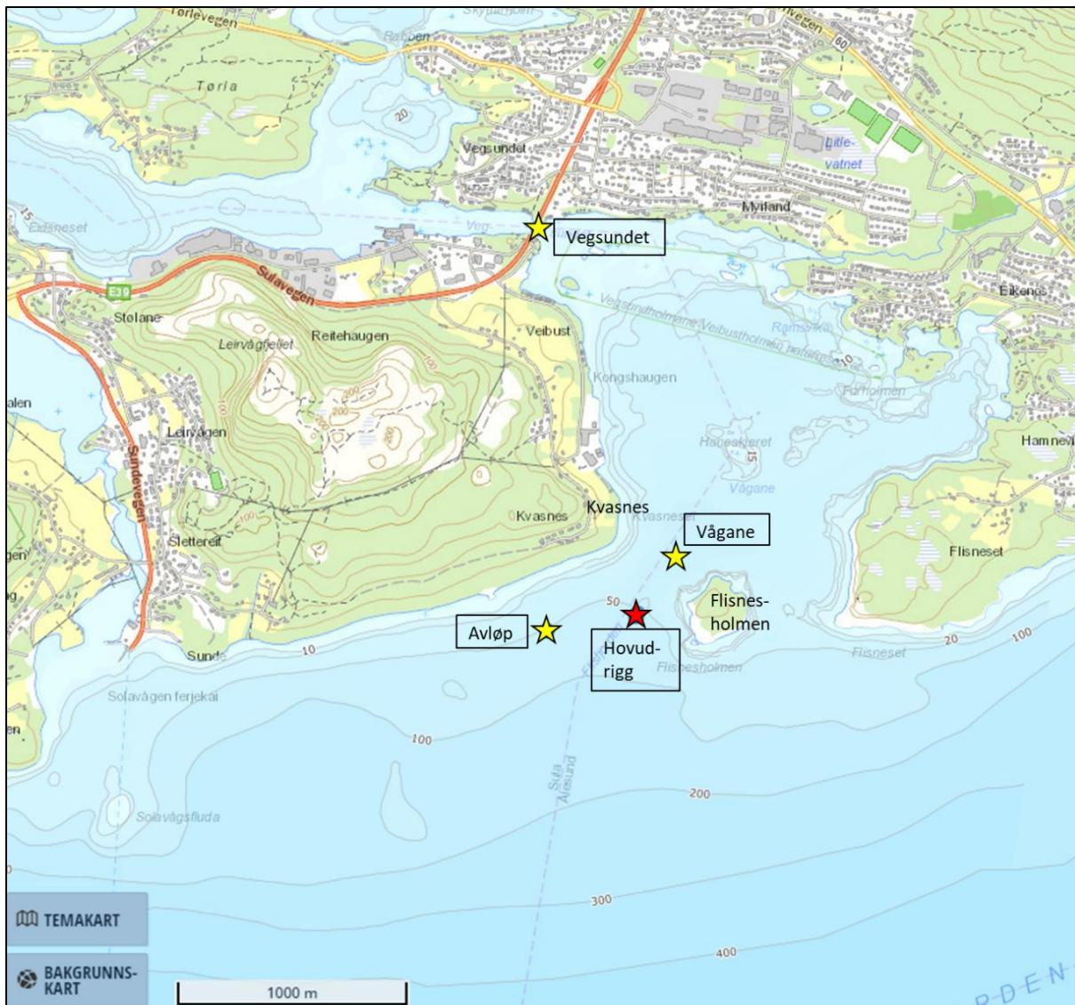
**Figur 8.** Oversikt over målestasjonar for straummåling. Raud stjerne viser posisjon for hovudriggen som stod på same stad heile måleperioden på eit år. Gule stjerner viser ulike posisjonar for måling med botnramma (jf. **tabell 3**).
