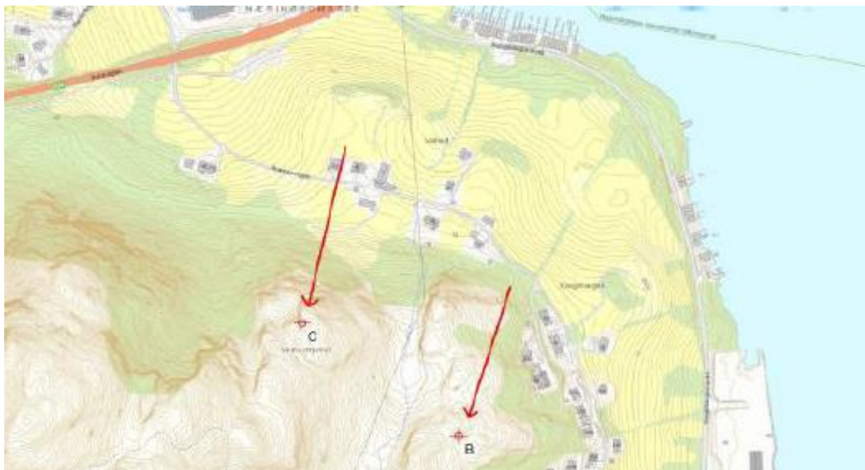
Figur 9: Forslag til plassering av luftepiper (15-20 meter høye).
