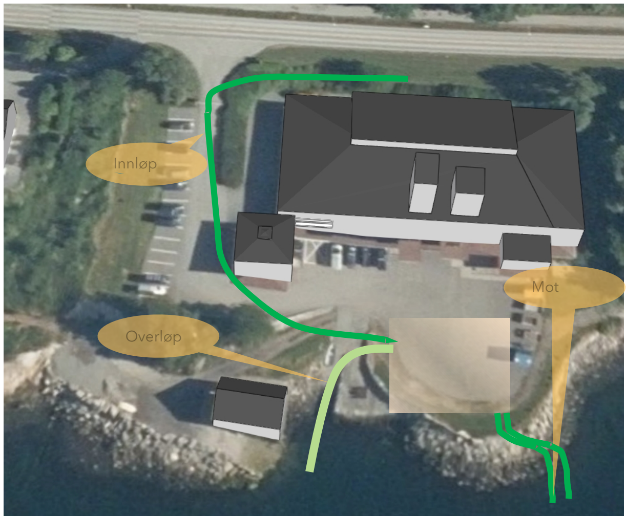
Figur 19: Skisse av prinsipp ledningsføring ved ny pumpestasjon ved RA4
