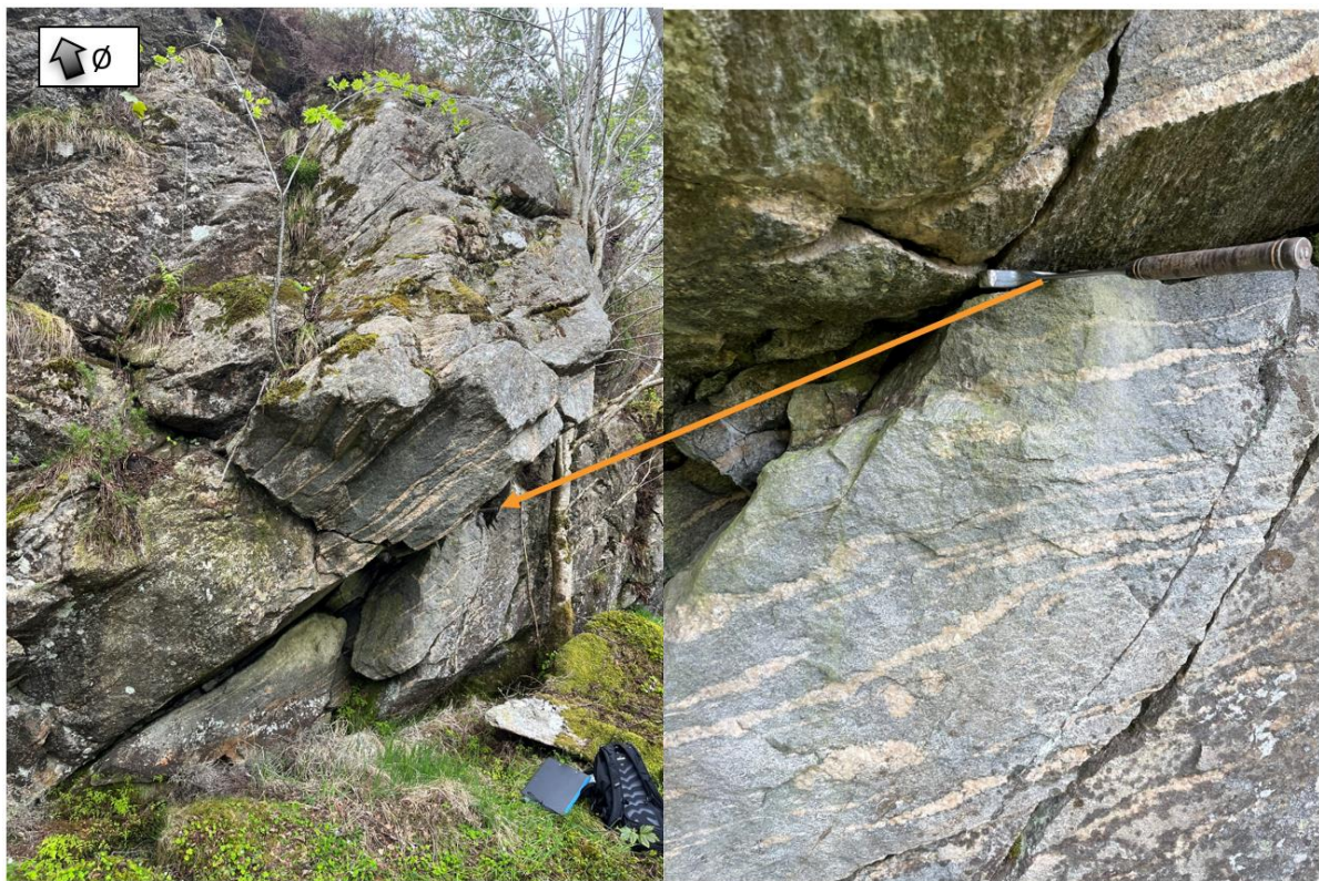
Figur 5: Bergblotning med detaljbilde som viser foliasjon. Infopunkt 4.
