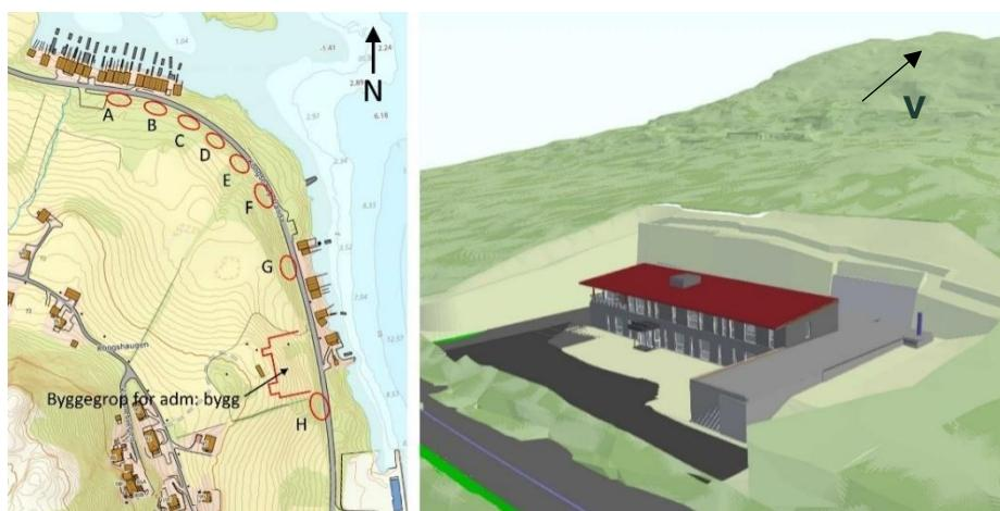
Figur 3: Oversiktskart (venstre) og perspektivvisning av tomt for administrasjonsbygg sett mot sør-sørvest (høyre). Røde sirkler indikerer hovedområdene hvor det skal etableres bergskjæringer langs GS-veg. Røde sirkler indikerer bergskjæringer ved tomten for administrasjonsbygget. Kilde bakgrunnskart: Norgeskart.no og utklipp fra samhandlingsmodell
