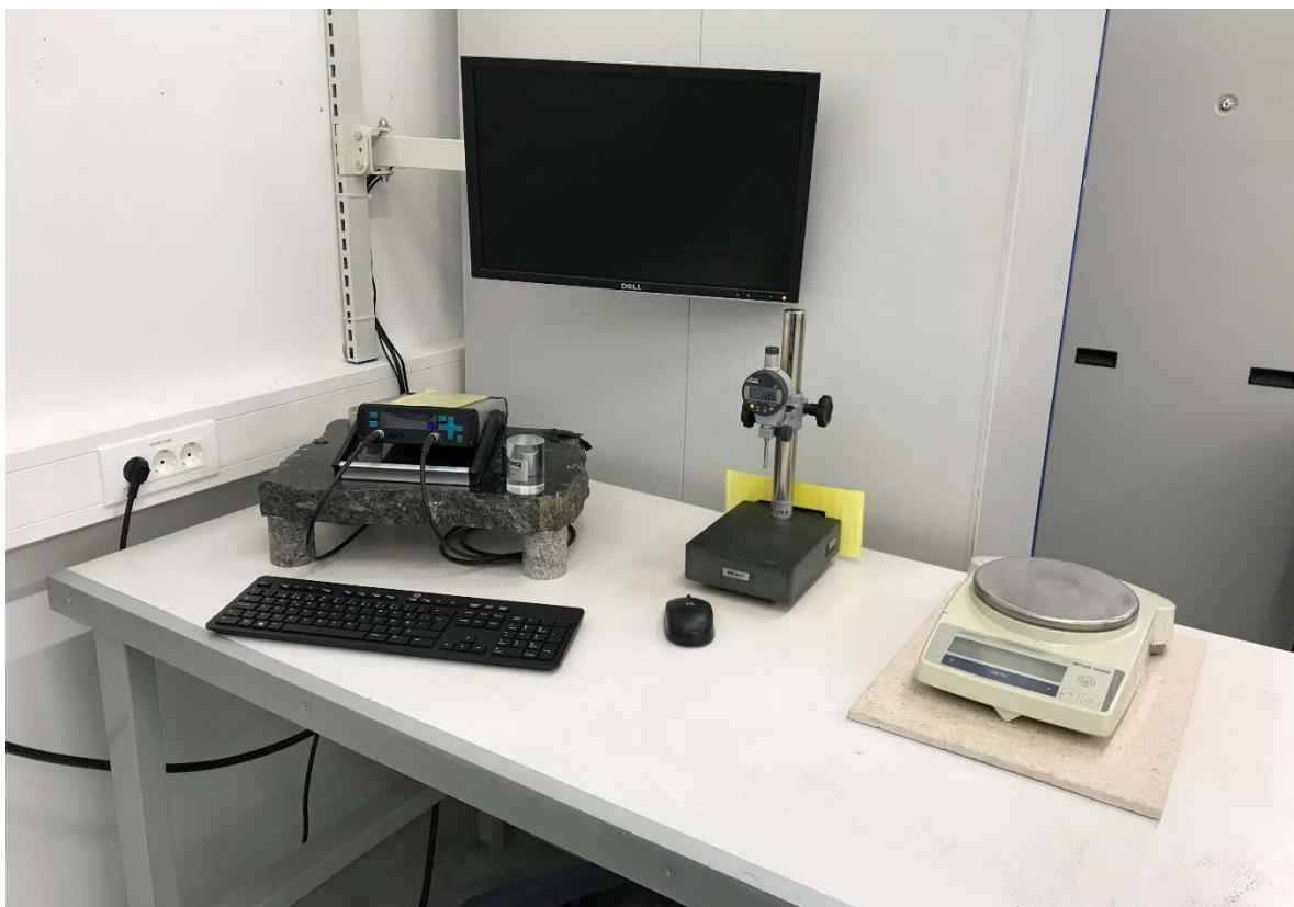
Pundit lab brukt til bestemmelse av lydhastighet, Mettler Toledo vekt og Mitutoyo skyvelære/høydemåler/planhetsmåler.
